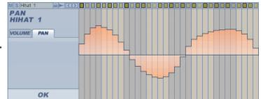
Dieser Graph ist bidirektional: der Minimalwert ist in der Mitte der vertikalen Achse, während ganz rechts oben und ganz links unten ist.
