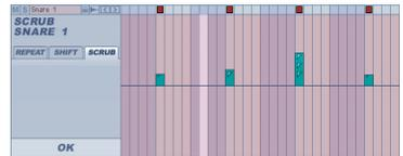
Dieser Graph Typ ist bidirektional: in der Mitte der senkrechten Achse findet keine Verschiebung des Startpunktes statt, ein Wert oberhalb der Mittellinie verschiebt den Startpunkt im Sample nach hinten, ein Wert unterhalb der Mittellinie verschiebt den Startpunkt im Sample nach vorne.
